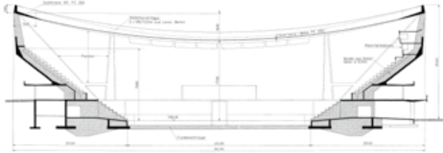
Querschnitt durch die St. Jakobshalle in Basel. Diese 90 m weit gespannte Hängeschale aus Leichtbeton wurde mit einer Plattenstärke von lediglich 7,5 cm realisiert.
