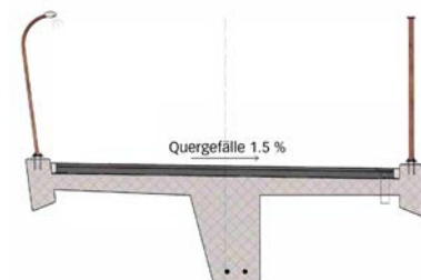
Querschnitt «Pons», Mst. 1:65.
